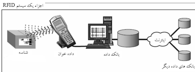
شکل ۲. اجزای یک سیستم RFID (منبع: اداره‌ی حساسرسی دولتی آمریکا)
